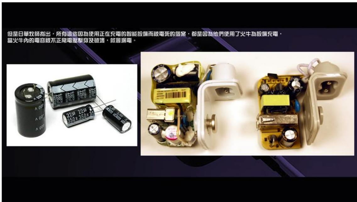
日華牧師補充，因為現今的智能設備所使用的小型充電火牛，內裡都是使用電容來變壓，不同以往的大型火牛，使用線圈用作電壓工具。
