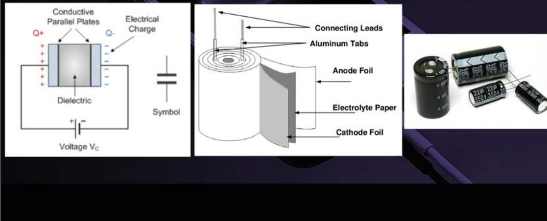
但是，假如火牛內的電容鋁片，因為不同原因被擊穿及破損，電容就會把電力公司提供的 220V 電壓，直接輸出到充電線及智能設備。
