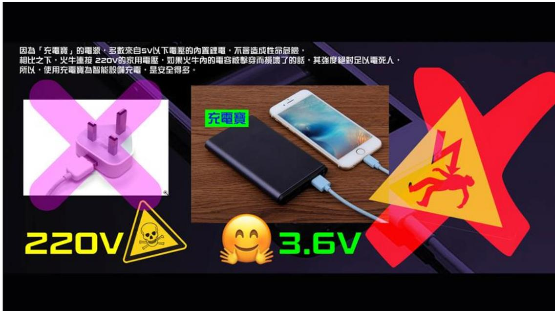
第二，一般質素較好的「充電寶」，都有滿電後自動停止輸電的設計，保護智能設備不會過度充電，同時，可以避免在 99% 至 100% 電量間，火牛不斷為智能設備充電，導致電池效能快速下降。
